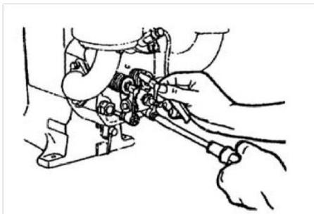
2. Зазор впускного клапана 0,20 мм. Зазор выпускного 0,25 мм.
