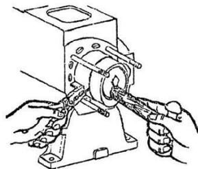
5. При установке впрыскивающего насоса после снятия, шток на топливном насосе и вилка регулятора оборотов должны быть совмещены.
